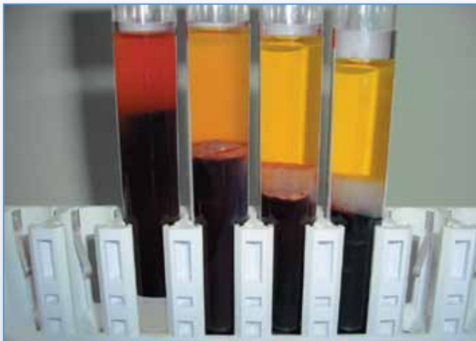
Abb. 35: Falsch zentrifugierte Trenngelröhrchen: Zentrifugationsdauer wurde nicht eingehalten. Von links nach rechts zunehmende Zentrifugationsdauer, rechts korrekt zentrifugiertes Trenngelröhrchen.
