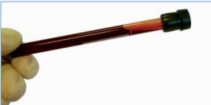
Abb. 27: „Wandernde Luftblase“ als Mischungsindikator
